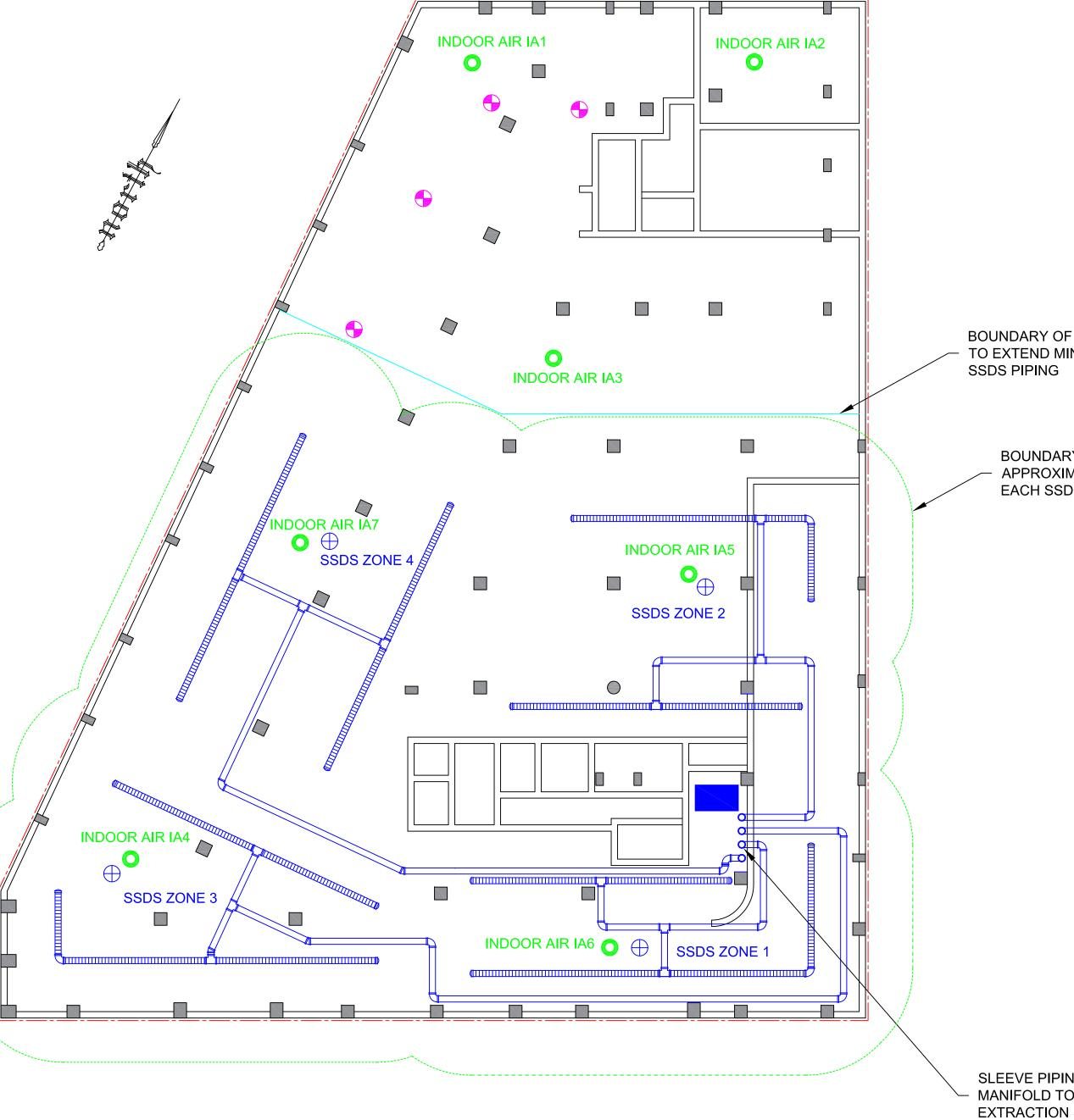
SSD SYSTEM PIPING PLAN (SUBSURFACE & GARAGE LEVEL) SCALE: 1/16" = 1'-0"
