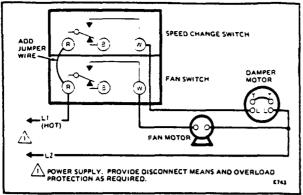
FIG. 6—T631B CONTROLLING SINGLE-SPEED FAN AND DAMPER MOTOR.
