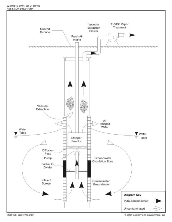
Figure 6-6 Typical Unterdruck-Verdampfer Brunner (UVB) Well Construction
