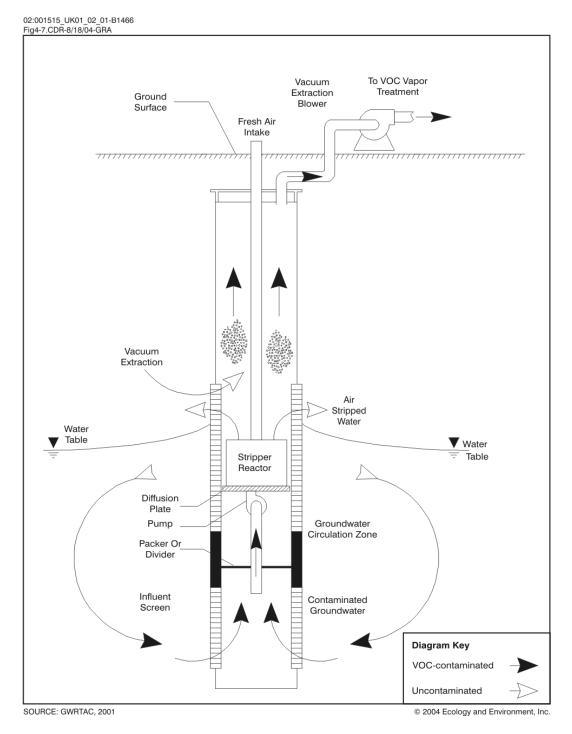
Figure 4-7 Typical Unterdruck-Verdampfer Brunner (UVB) Well Construction
